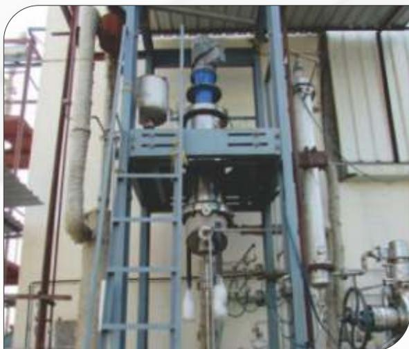
Экспериментальная установка Finerac специально создана для тестирования производительности насадок. Ниже приведены ключевые особенности установки:
