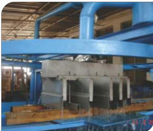
Каждый распределитель Finerac проходит тестирование на нашей установке для тестирования распределителей на качество с помощью воды. Ниже приведены ключевые особенности установки.
